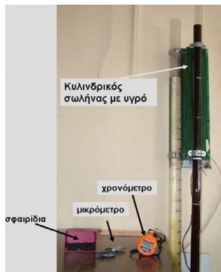
Σχήμα 2: Πειραματική διάταξη για τον προσδιορισμό του συντελεστή εσωτερικής τριβής υγρού
